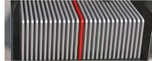
**2. Geração de Gás:** As altas temperaturas provocam a decomposição de componentes eletrolíticos, levando à liberação de gases inflamáveis, como hidrogênio e monóxido de carbono. A geração de gás contribui para o aumento da pressão dentro da célula.
